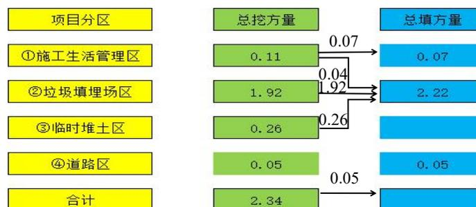
图 1-8 项目土石方平衡及流向图 单位：m<sup>3</sup>
