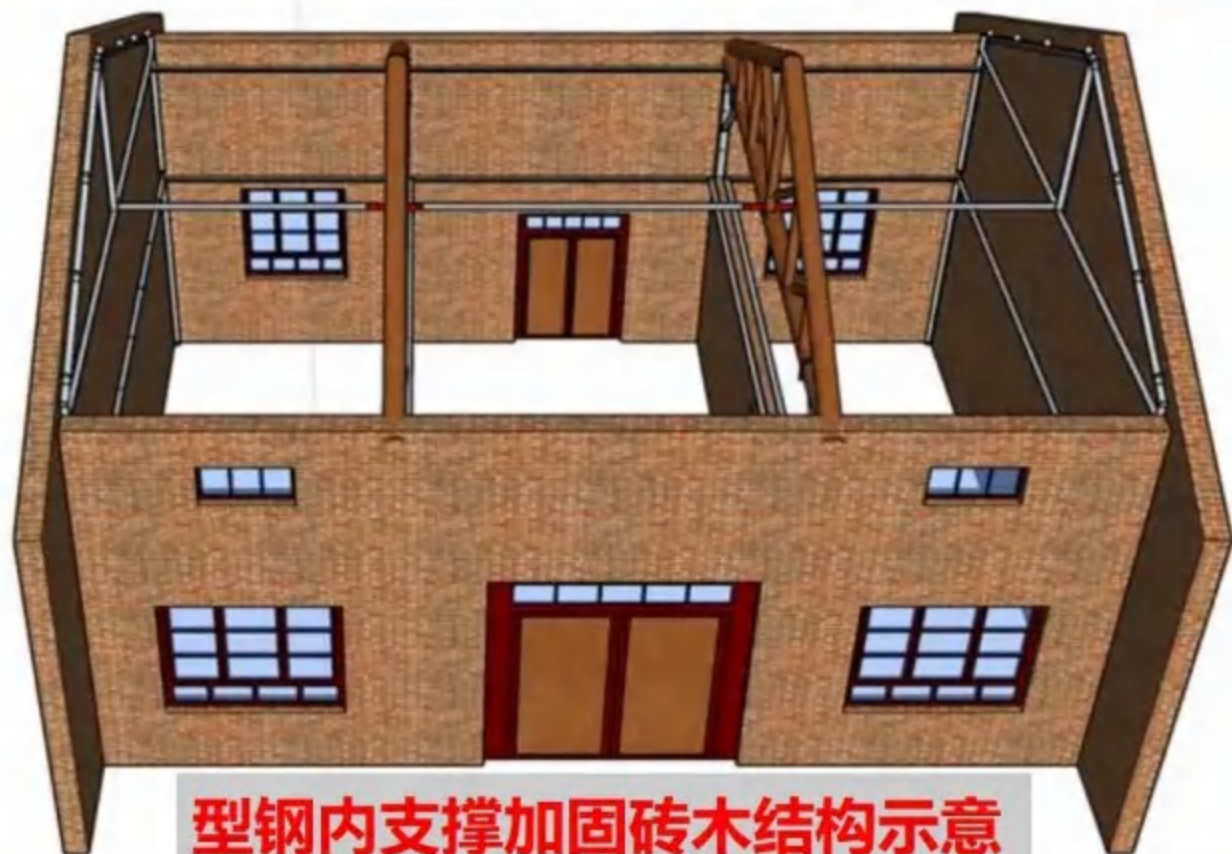
型钢内支撑-外设墙揽加固土木结构
